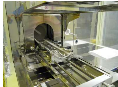
電気炉 光洋リンドバーク M200、M300 4inch Si ウエハの酸化、拡散が可能
