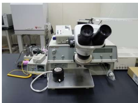
ワイヤーボンディング装置 WEST-BOND Auワイヤー
