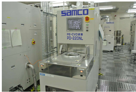
PE-CVD装置 サムコ PD-200NL
