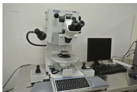
ダイシエータテスト装置 デイジ 4000P 接合強度の評価
