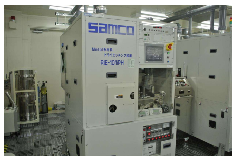
Si系材料ドライエッチング装置 サムコ RIE-101iPH（フッ素ガス仕様）
