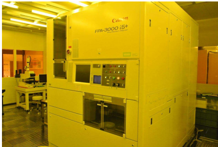
縮小投影露光装置 キヤノン FPA-3000i5 i線露光、φ4inchSiウエハおよび35mm各基板対応
