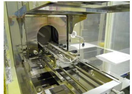
電気炉 光洋リンドバーク M200、M300 4inch Si ウエハの酸化、拡散が可能
