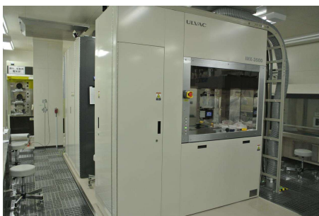
イオン注入装置 ULVAC IMX-3500 リンおよびホウ素のイオン注入
