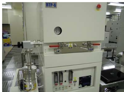
高速熱処理炉 ULVAC RTP-6 極薄酸化膜形成用、φ4inch基板対応
