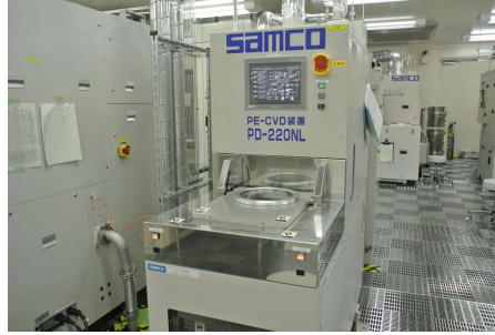
PE-CVD装置 サムコ PD-200NL
