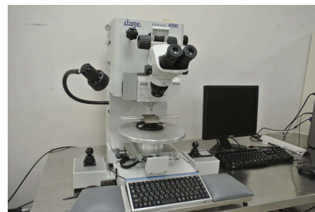
ダイシエータスター装置 デイジ 4000P 接合強度の評価
