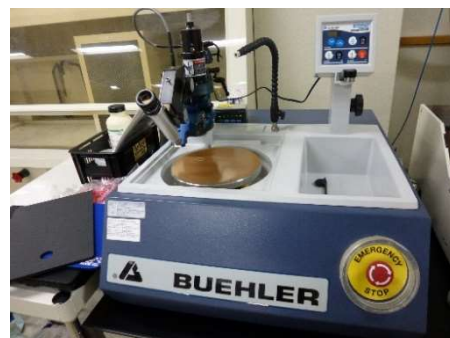
断面研磨装置 BUEHLER SEM、AFM、SCM断面観察試料作製
