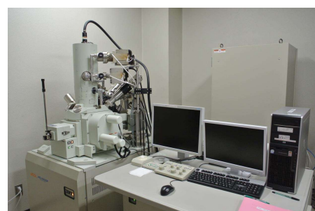
FIB/SEM複合装置 JEOL JIB-4600F 加工、表面・断面観察
