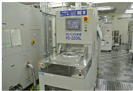
PE-CVD装置 サムコ PD-200NL
