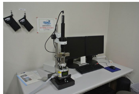
SCM/SPM装置 日本ビーコ MultiModeVS SPM 表面形状観察
