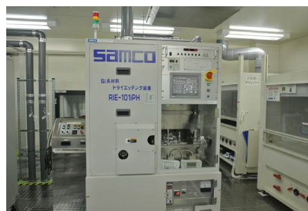
Metal系材料ドライエッチング装置 サムコ RIE-101iPH（塩素ガス仕様）
