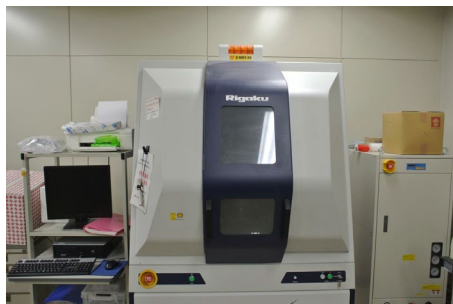
X線分析装置 リガク SmartLab 結晶構造解析、配向性評価
