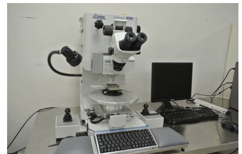
ダイシエータ装置 デイジ 4000P 接合強度の評価
